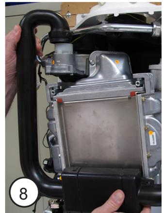
8. Entfernen Sie den Luftzufuhrdämpfer;
