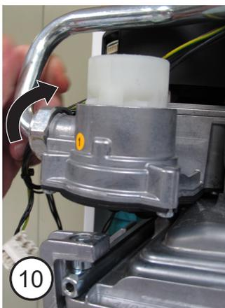
10. Lösen Sie die Überwurfmutter der Venturieinheit;
