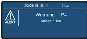
Sinkt der Wasserdruck unter 1,0 bar, wird im Bildschirm "Warnung 1P4" angezeigt.
