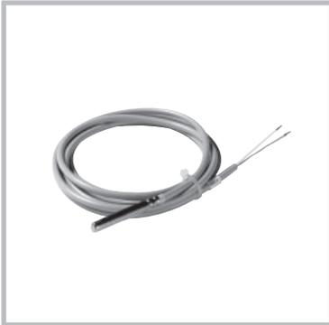
**Elektronischer Speicherfühler** zur Ansteuerung eines Speichers über Dreiwegeventil ohne Speicherthermostaten bzw. in Verbindung mit ATAG One zur Eingabe verschiedener Warmwassertemperaturen und Legionellenschutzschaltung. Wird bei dem Anschluss eines Fremdspeichers an ein Gerät der QR-Serie benötigt.
