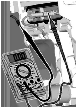
Messung des Ionisationsstromes Bild 10.3.g
