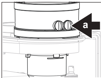
Messpunkt Abgassonde Bild 9.5.a
