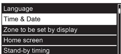
4 Mit „+“ nach unten und mit „-“ nach oben scrollen, um **Time & Date (Datum & Uhrzeit)** zu markieren.
