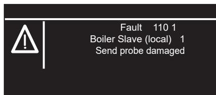
Fehler direkt am Slave-Heizkessel.
