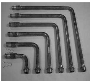
Rohrsatz QR-CC Anschlüsse links und rechts für Q25CCR und Q30CCR für den seitlichen Anschluss links und rechts (Vorlauf, Rücklauf, Kaltwasser, Warmwasser, Gas, Zirkulation) mit 22 mm Kupferrohr, inkl. Übergängen auf 3/4" Außengewinde, Dichtungen und Sicherungsfedern, mit Isolierung
