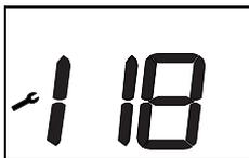
Sinkt der Wasserdruck unter 1,0 bar, wird im Display der Code 118 angezeigt.
