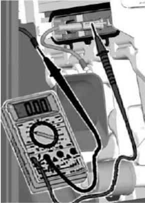
Messung des Ionisationsstromes Bild 11.3.e
