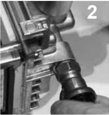
Zum Austausch des Ventils muss das Gerät entleert werden.
