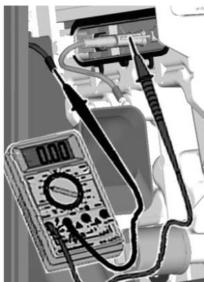
Messung des Ionisationsstromes Bild 11.3.f
