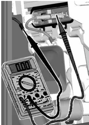
Messung des Ionisationsstromes Bild 12.6.e
